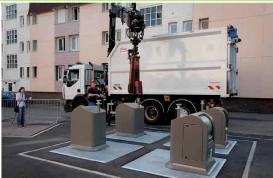
Enfin, il est indispensable de faciliter l'accessibilité au PAV par les camions de collecte dotés d'un bras télescopique en :
